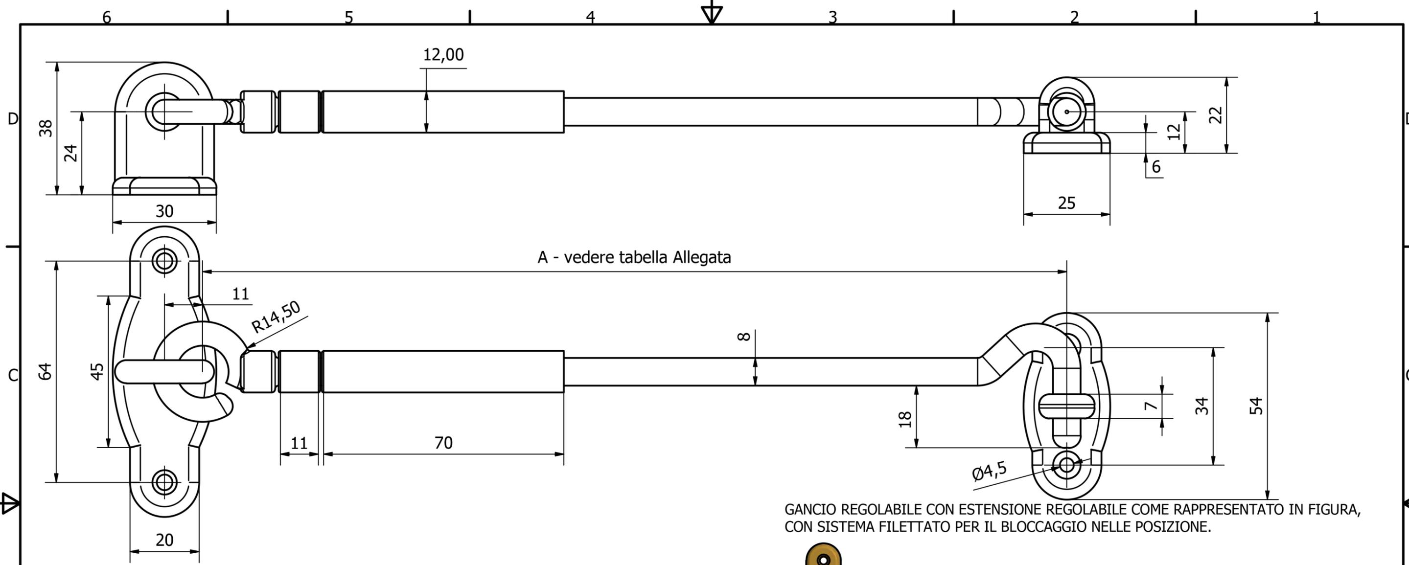
GANCIO REGOLABILE CON ESTENSIONE REGOLABILE COME RAPPRESENTATO IN FIGURA, CON SISTEMA FILETTATO PER IL BLOCCAGGIO NELLE POSIZIONE.
